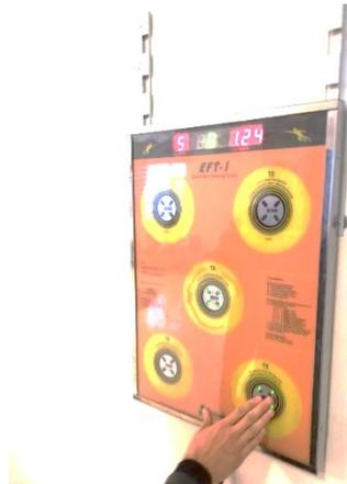
الحركة وبعد أداء (١٠) محاولات الجهاز مباشرةً عن طريق شاشة خاصة يستخرج معدل زمن رد فعل الحركة لجميع المحاولات، وكما هو موضح في الشكل (٣).
